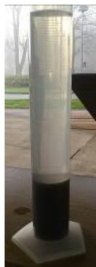
odmerný valec po 30 min. sedimentácie. Zreteľné rozhranie kalu a vody (Tu napr. Nízka koncentrácia kalu)
